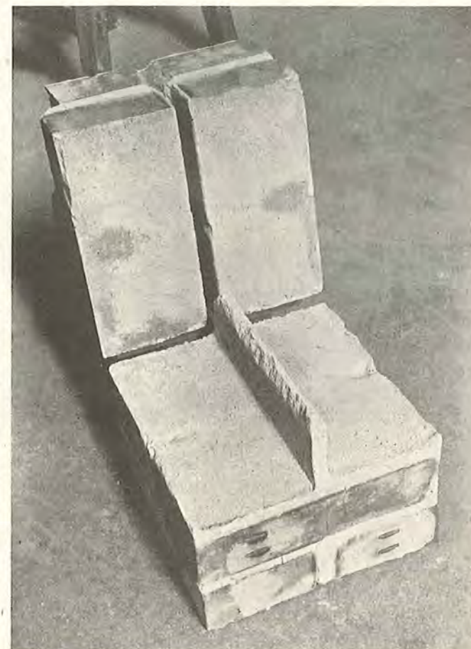
Fig. 24. Midterskifterne i en Pille af vanddrukte Molersten i Kalk-Cement-Mørtel. Efter Brud kunde Pille adskilles som vist. I Liggefugens Overside ses Lunke, og de mørke Pletter paa Undersiden af de overliggende Sten er Omraader, fra hvilke Mørtlen er sunket ned.
